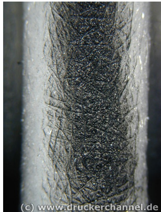
Makroaufnahme: Filterstab nach rund 20000 Seiten!
